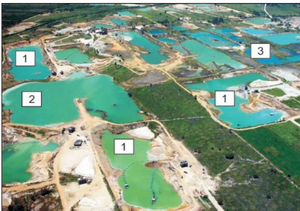
Figura 6 – Vista aérea de parte do distrito areeiro Itaguaí-Seropédica. Nesta Figura, é possível identificar lagoas de extração ativas (1), lagoas de decantação (2) e lagoas desativadas (3).
