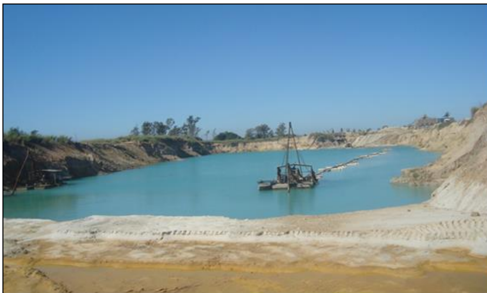
Figura 5 – Dragagem de areia em cava submersa na área estudada, 2016.
