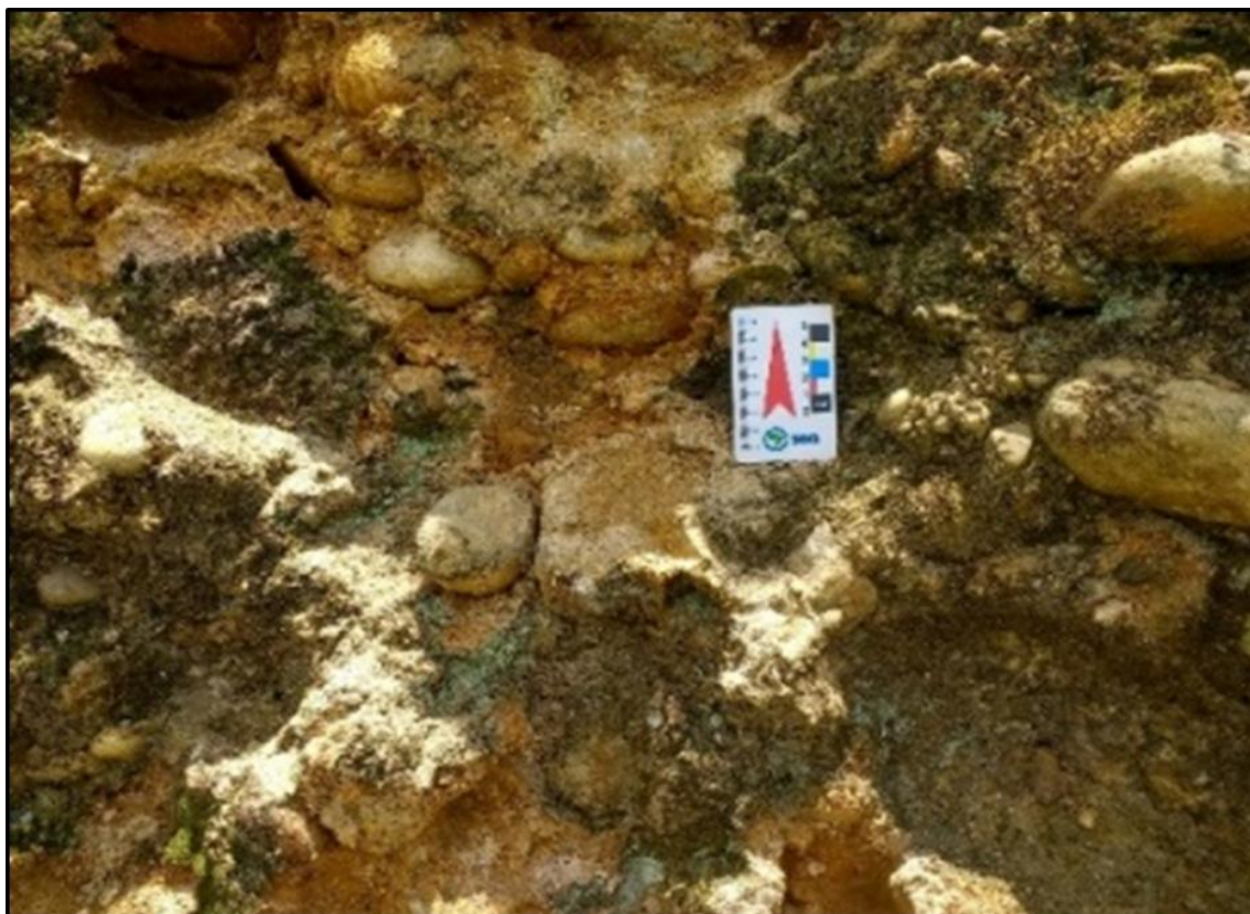
Figura 19: Aspecto do conglomerado descrito acima, observando-se o arcabouço constituído por seixos arredondados e a consistência da rocha sedimentar proporcionada pelo cimento filossilicático.
