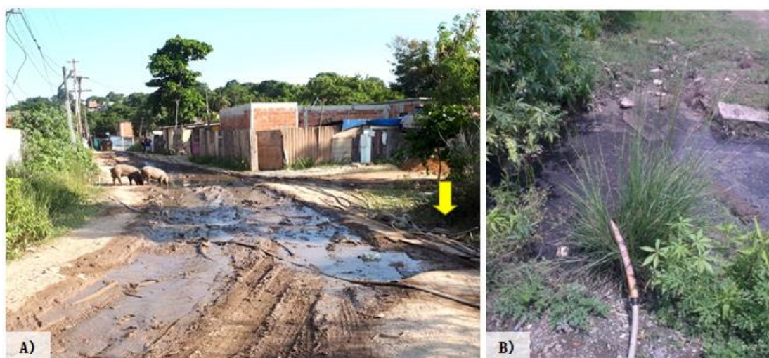
Figura 6 - a) Mangueiras direcionando a água da rede geral aos domicílios. Destaca-se que não houve chuva na semana da captura da foto, logo o estado da via de acesso se dá pelas mangueiras de água e pelo constante fluxo de caminhões de lixo. b) Mangueira de água sobre vala de esgoto.
